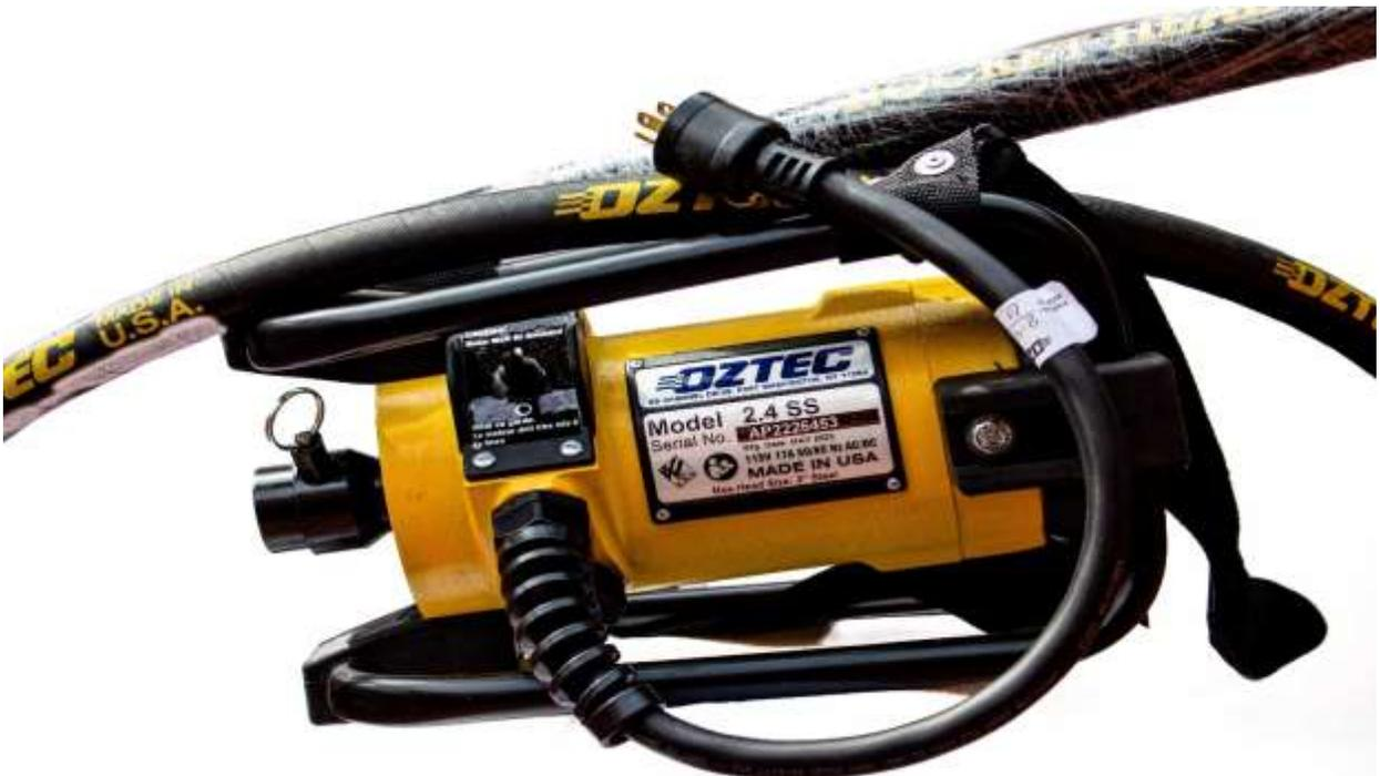
Un **vibrador interno de concreto**: es una máquina que consta de un motor o unidad eléctrica, una manguera o eje flexible y un cabezote vibratorio de acero que se sumerge en el interior del [hormigón](#) fresco vertido en obra para mejorar su resistencia mediante la reducción del nivel de aire ocluido y una mejor distribución de las partículas.
