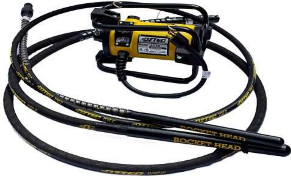
Un **vibrador de inmersión para concreto**: es una máquina que consta de un motor o unidad eléctrica, una manguera o eje flexible y un cabezote vibratorio de acero que se sumerge en el interior del [hormigón](#) fresco vertido en obra para mejorar su resistencia mediante la reducción del nivel de aire ocluido y una mejor distribución de las partículas.
